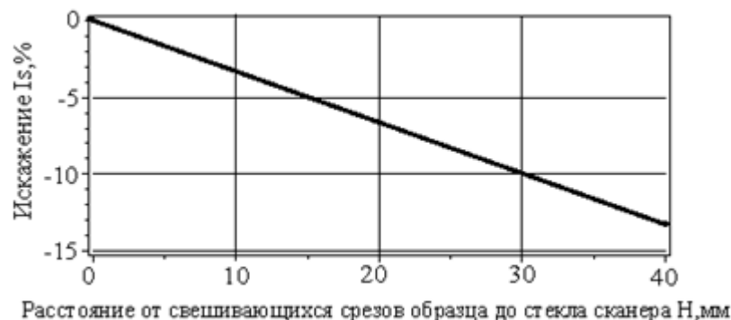
Рисунок П2.2 – Изменение размеров образца по площади
