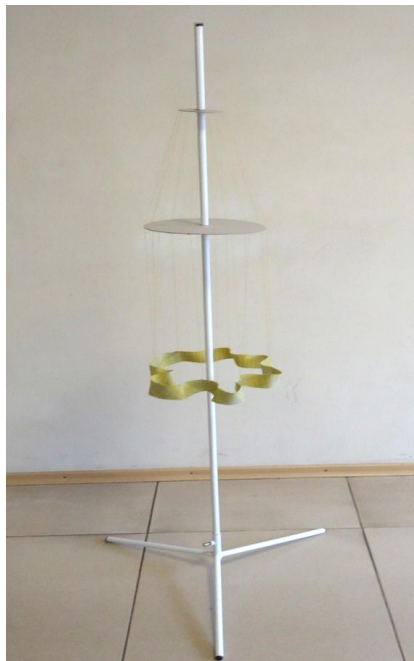
Рисунок 3.10 – Стенд для исследования пространственной формы замкнутого элемента тонкой оболочки
