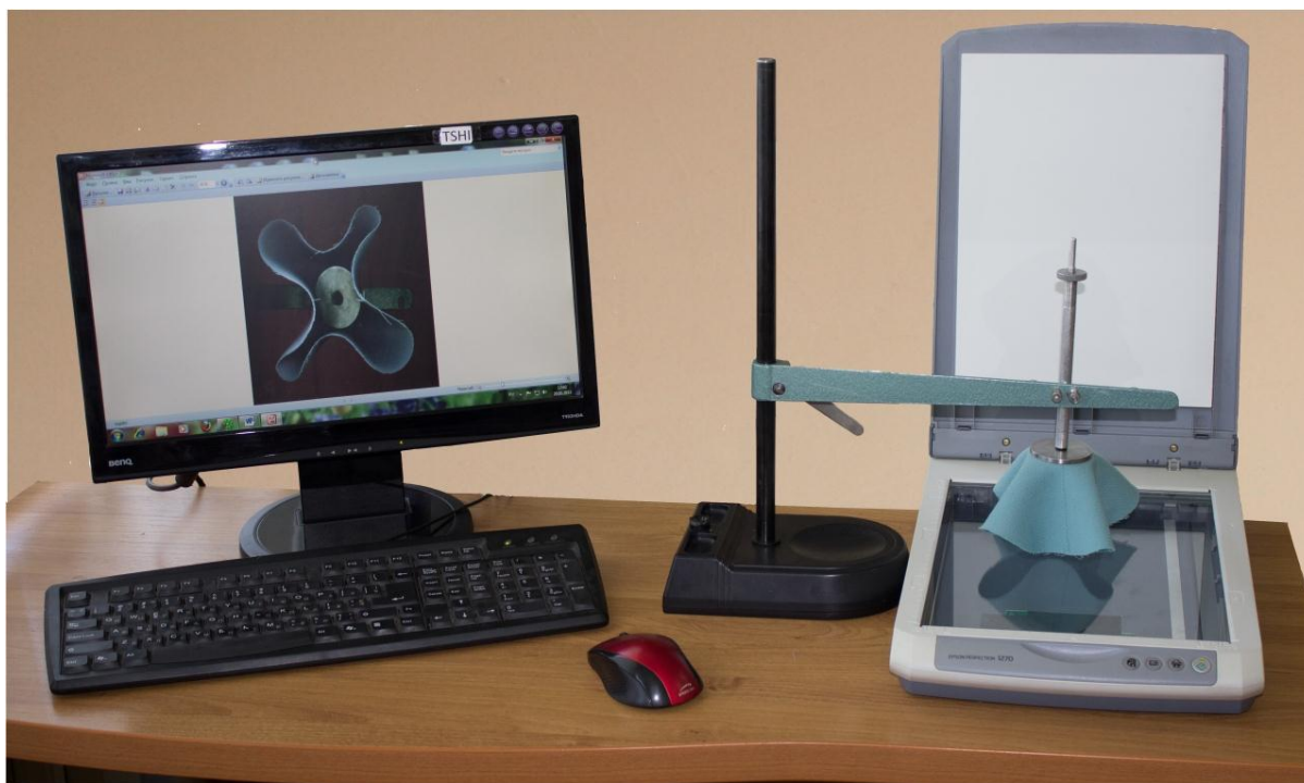
Рисунок 3.5 – Установка для определения драпируемости материалов
